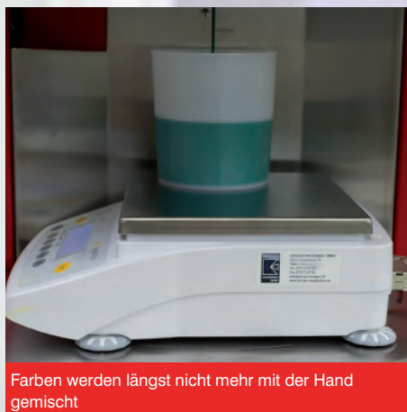
Ein computergesteuertes Farbmischsystem sichert die genaue Reproduzierbarkeit der Farben für die Serienproduktion
