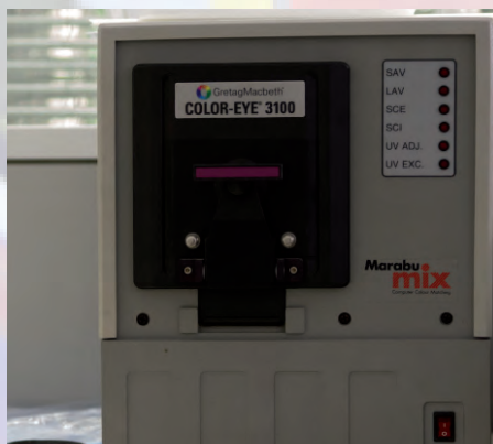
Besser als das menschliche Auge: der Farbmesser Colour Eye 3100
