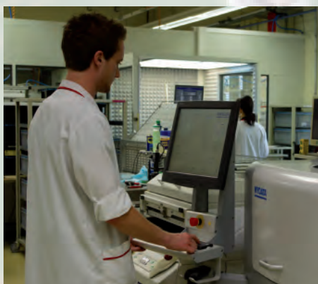
Der Lötpastendrucker von MyData ist das jüngste Mitglied im Maschinenpark
