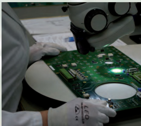
Die optische Zwischenkontrolle der bestückten Bauteile wird mit großer Aufmerksamkeit durchgeführt
