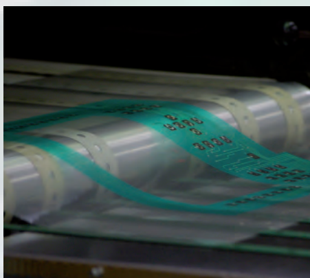
Der Zylinderdruck hat einen hohen Durchsatz an Bögen
